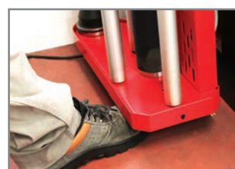
PROTEZIONE PARACADUTE CARRELLO SAFETY STOP DEVICE
